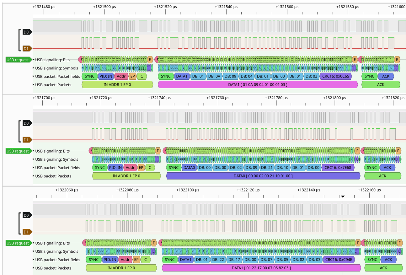
Рис. 10.5в. Хост многократно отправляет токены IN и получает от устройства следующую порцию данных в пакетах DATAx подтверждая прием отсылкой токена ACK.
