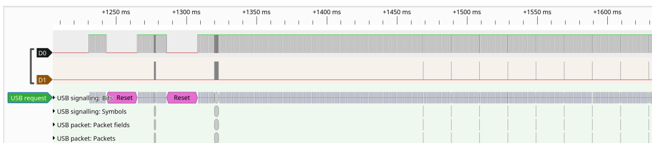
Рис. 10.1. Общий вид процедуры инициализации USB устройства.
