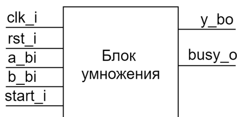
Рисунок 2.8 – Интерфейс аппаратного блока умножения
