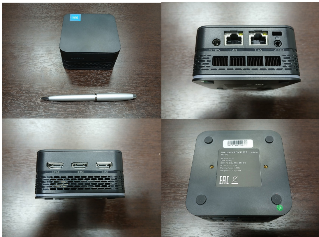
Рис.2. Мини-ПК Horizon N5 DN5122P [PCMI-0105], процессор Intel Celeron N5105 (4 ядра по 2.0 ГГц), 12 ГБ DDR4, 256 ГБ SSD, 2x1GbitEthernet, 3xUSB и 3xHDMI.
