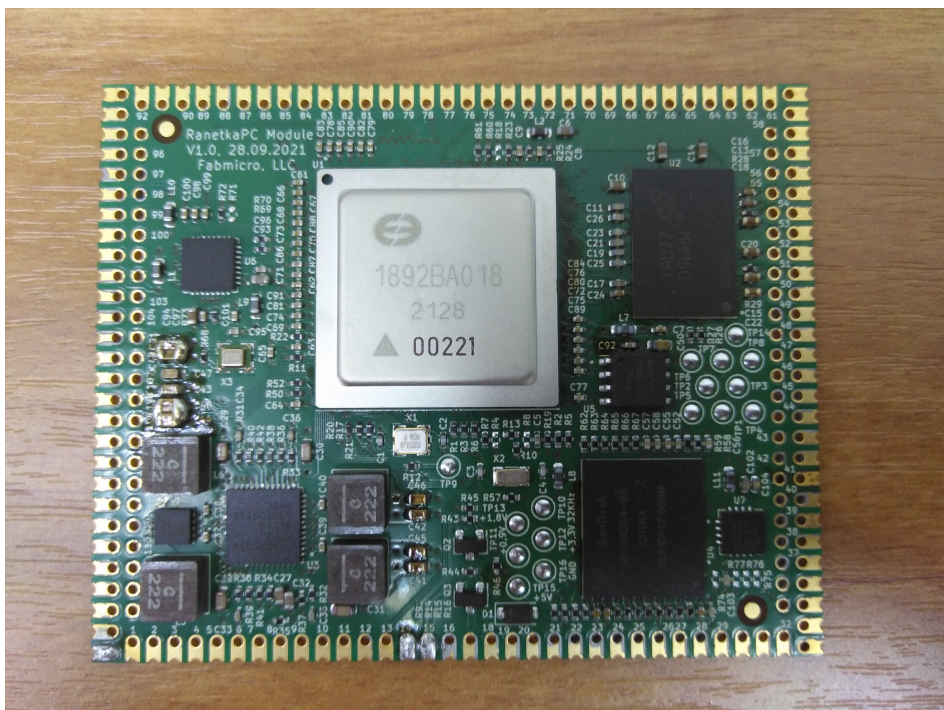
Рис. 4. Процессорный модуль «RanetkaPC» версии 1.0, инженерный образец. ООО «Фабмикро», Февраль 2022.
