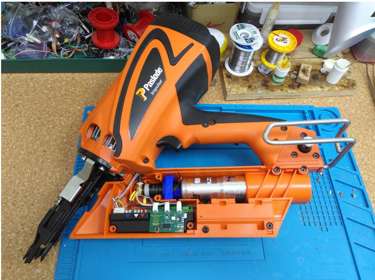
Рис. 1. Paslode Impulse IM100Ci с установленной платой блока обхода электронного поводка.
