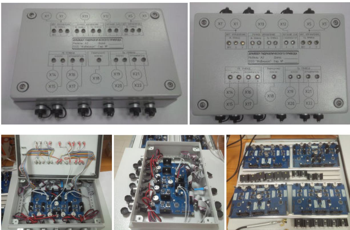
Блок драйвера клапанов *ValveDriver A4* предназначен для управления системной дифференциальных электромагнитных клапанов в составе рулевой системы речных судов с водометным или винтовым приводом.
