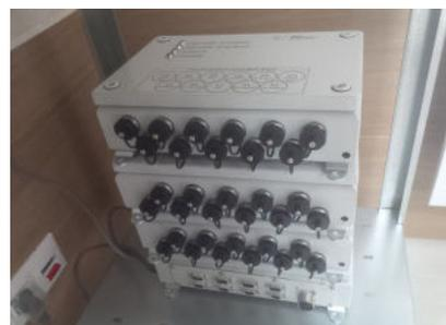
RiverRide представляет собой законченный микроконтроллерный блок управления рулевой системой речных судов с водомётным или винтовым приводом. RiverRide имеет два независимых канала - правый и левый, может управлять насадками/заслонками с помощью шаговых двигателей, сервоприводов или системой гидравлических цилиндров. Богатый выбор настроек позволяет адаптировать RiverRide к работе практически с любым видом приводов.
