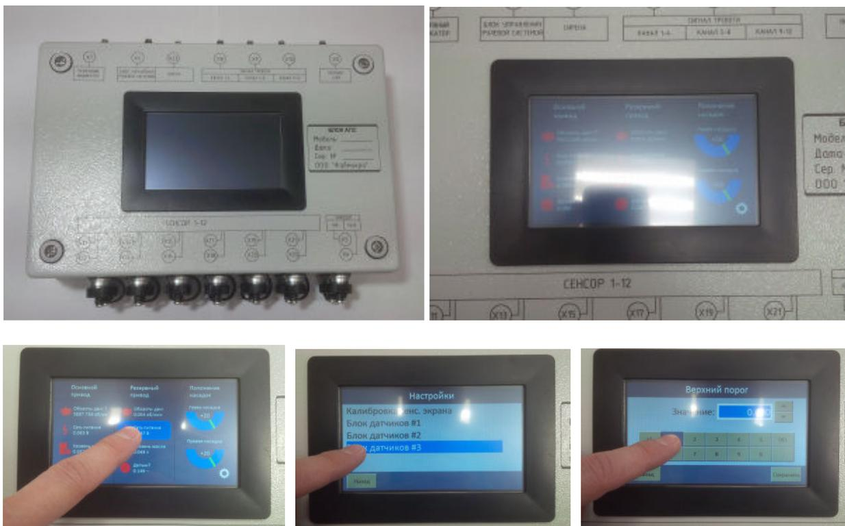
Блок аварийно-предупредительной систем **APS A2** предназначен для сбора информации о состоянии узлов и агрегатов рулевой системы речных судов, отображения этой информации на цветном графическом Ж/К дисплее, передачи её в блок управления релейной системой (см. **RiverRide B4**) по цифровому каналу, а также для формирования дискретных сигналов тревоги и управления сиреной.
