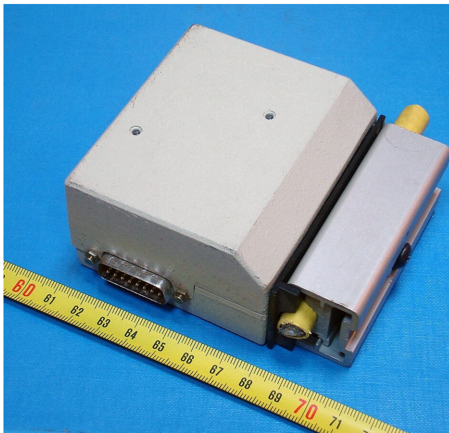
Рис. 29. Трансивер сети Ethernet (10Base-5) буквально «врезался» в коаксиальный кабель.
