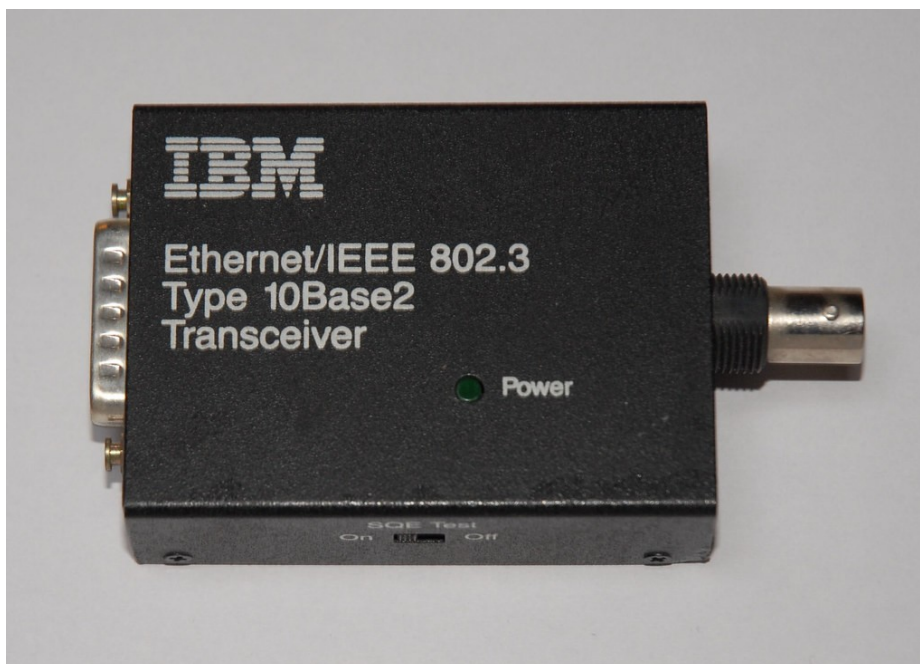
Рис. 30. Трансивер Ethernet стандарта 10Base-2 подключался к «тонкому» коаксиальному кабелю через разъем типа BNC.
