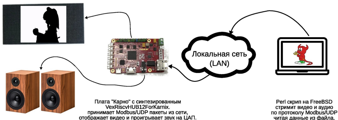
Рис.37. Плата «Карно» с загруженным проектом VexRiscvWithHUB12ForKarnix принимает из сети пакеты Modbus/UDP , изымает из них аудио и видео данные и проигрывает их на имеющейся аппаратуре.
